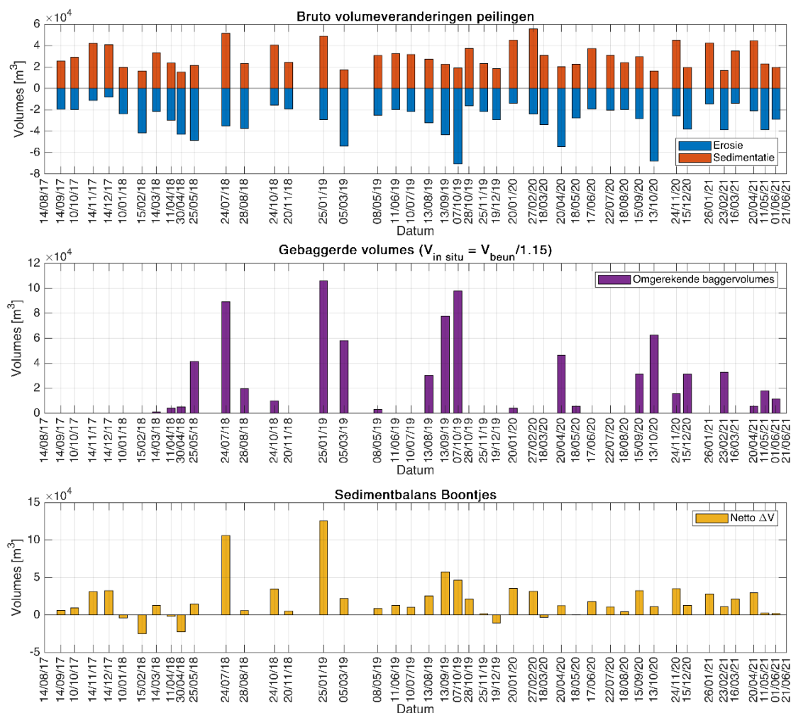
Figuur 4.10 Sedimentbudget van de vaargeul Boontjes. Het bovenste paneel toont de totale gemeten sedimentatie/erosie volumes per periode. Het middelste paneel toont de berekende in-situ baggervolumes. Het onderste paneel toont de netto sedimentvolumeveranderingen (= sedimentatie-erosie-baggervolumes). De kolommen zijn geplaatst aan het eind van de beschouwde periode (voorbeeld: de kolom op 14/09/2017 toont de volumeveranderingen voor de periode 14/08/2017 – 14/09/2017).
