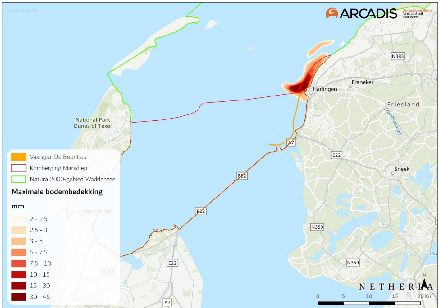
Figuur 6-7 Maximale sliblaagdikte door verspreiden sediment uit vaargeul Boontjes en haven van Harlingen.
