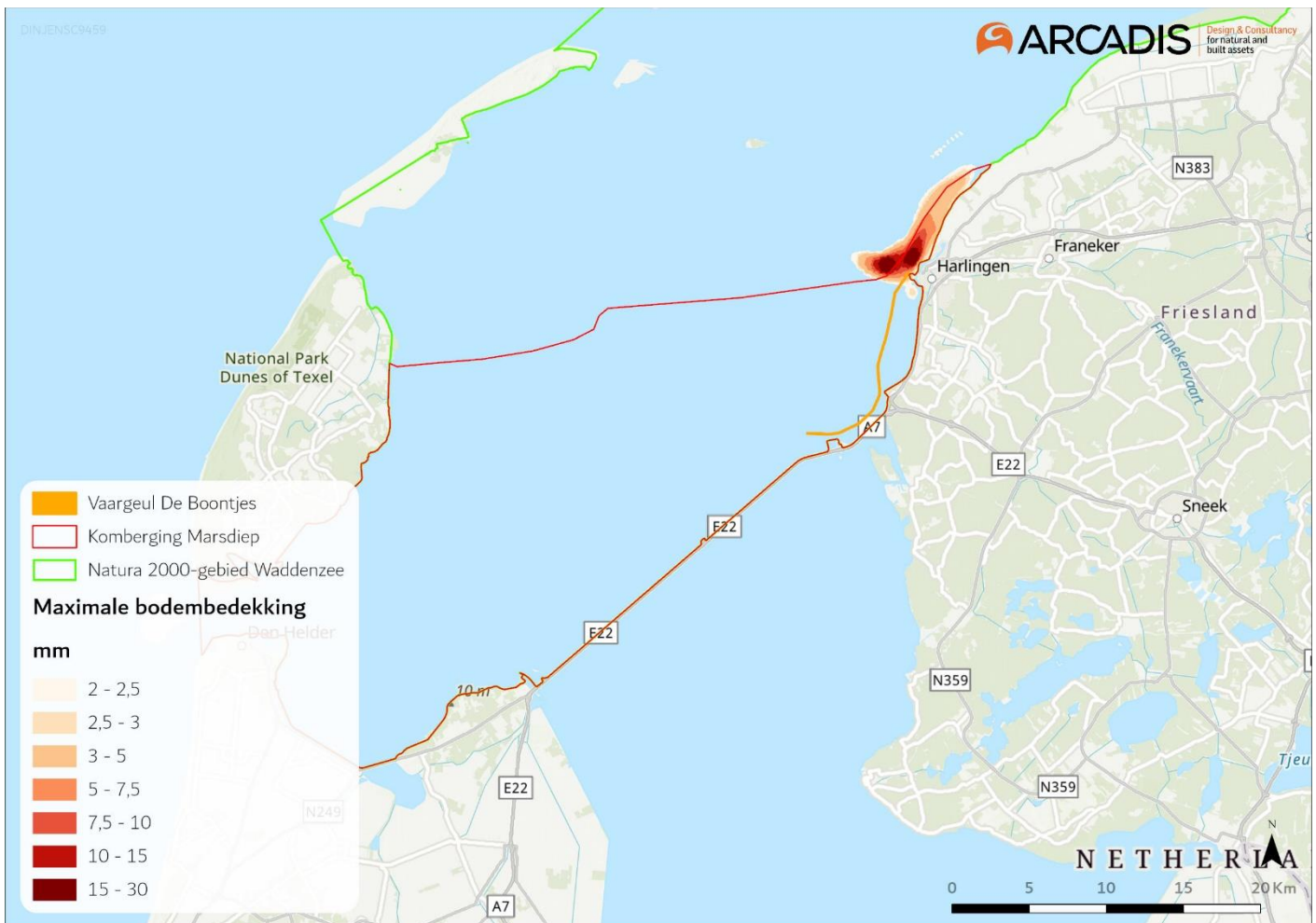
Figuur 4-4 Maximale sliblaagdikte door verspreiden sediment uit vaargeul Boontjes (scenario 1, maximale maandelijkse verspreiding)
