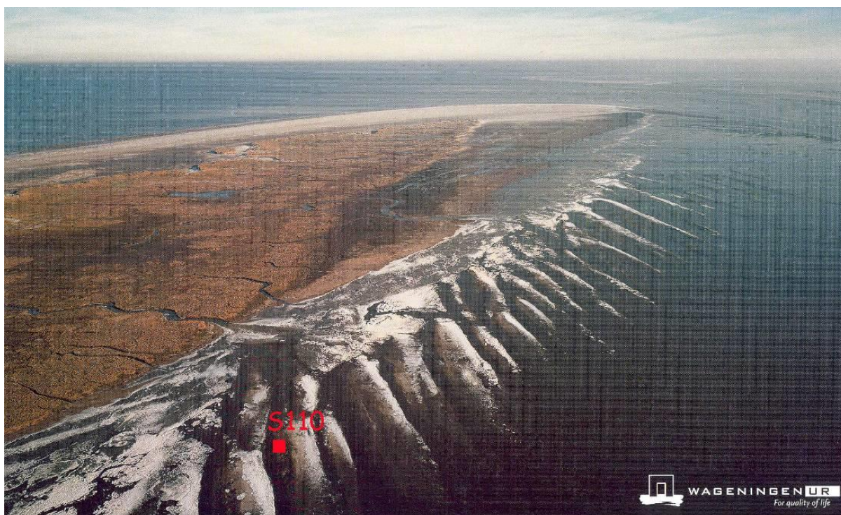
Figuur 2.37 Meetstation S110 op luchtfoto. Zandgolven veroorzaken lokale dynamiek.
