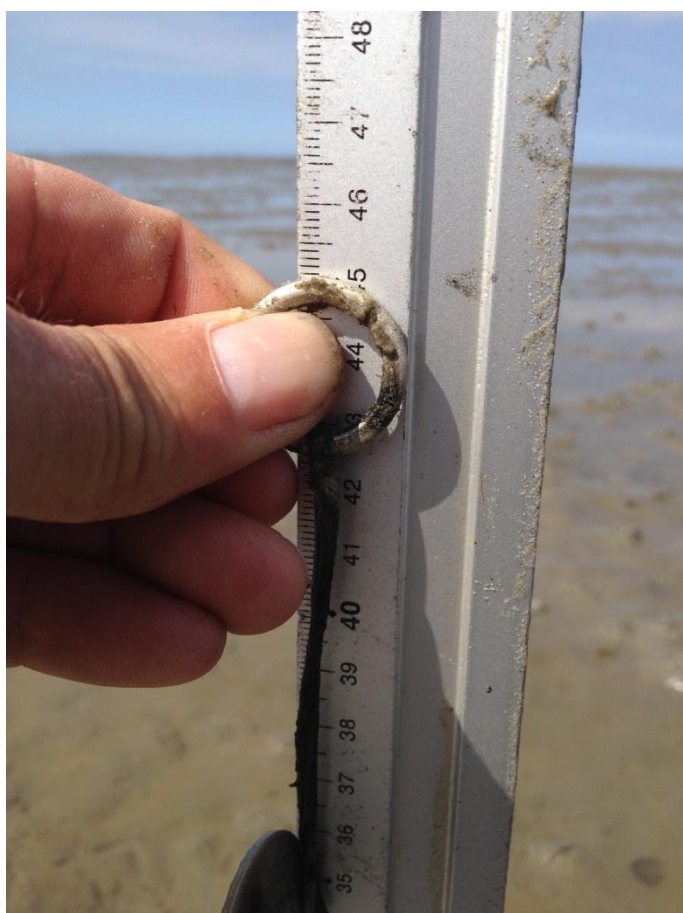
Figuur 2.31 Meetliniaal met brede meetvoet (niet zichtbaar). Deze wordt steeds op dezelfde wijze op de bodem gezet waarna de lengte van de dyneema lijn langs de schaal wordt afgelezen. In dit geval 45,1 cm..
