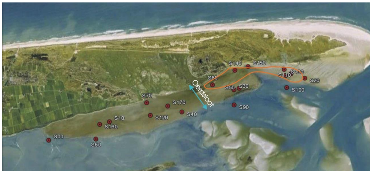
Figuur 2.42 In het oranje gebied is sprake van netto maaiveld daling ten gevolge van diepe daling door gaswinning.
