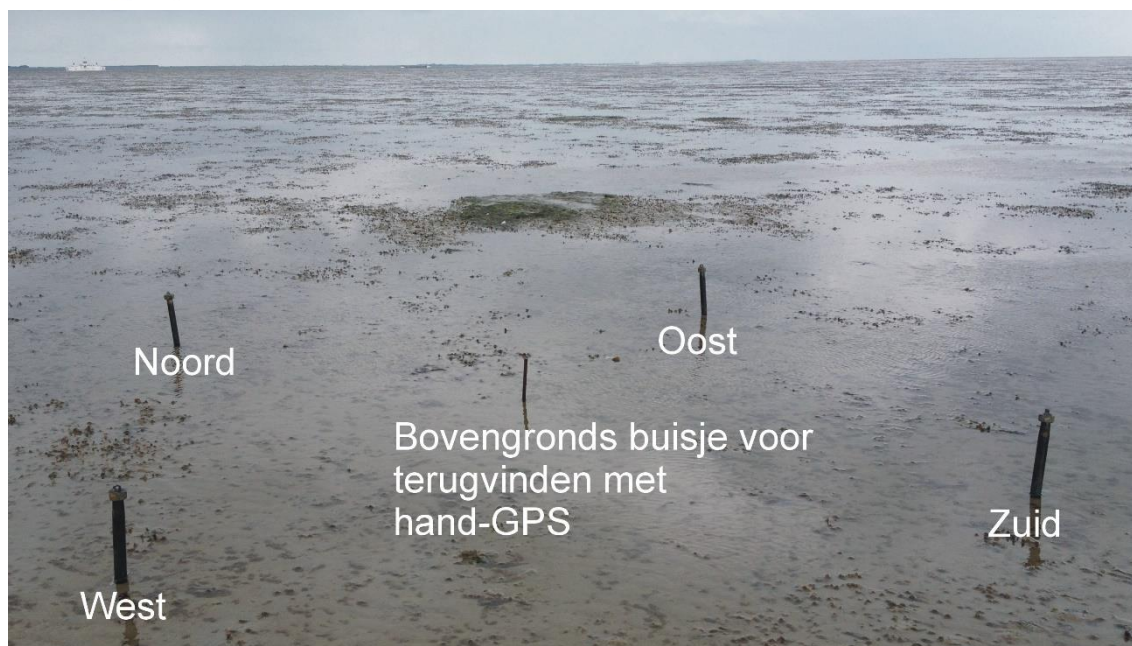
Figuur 2.28 De 4 grondankers die ongeveer 80-100 cm onder het oppervlak worden geschroefd. Hieraan is een dyneema lijn met aan het bovengrondse deel een identificatieblikje en aluminium afleesring bevestigd.
