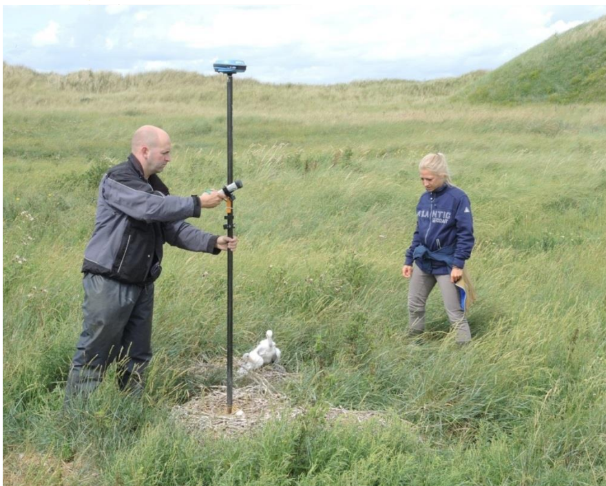
Figuur 5.5 De XYZ coördinaat van de nestkom van de nesten en een grid over het maaiveld van de kolonie wordt jaarlijks aan het eind van het broedseizoen ingemeten met een RTK/DGPS apparaat. Op de foto zijn nog enkele late jongen aanwezig. Hon, 12 aug 2013. Foto: J. Krol
