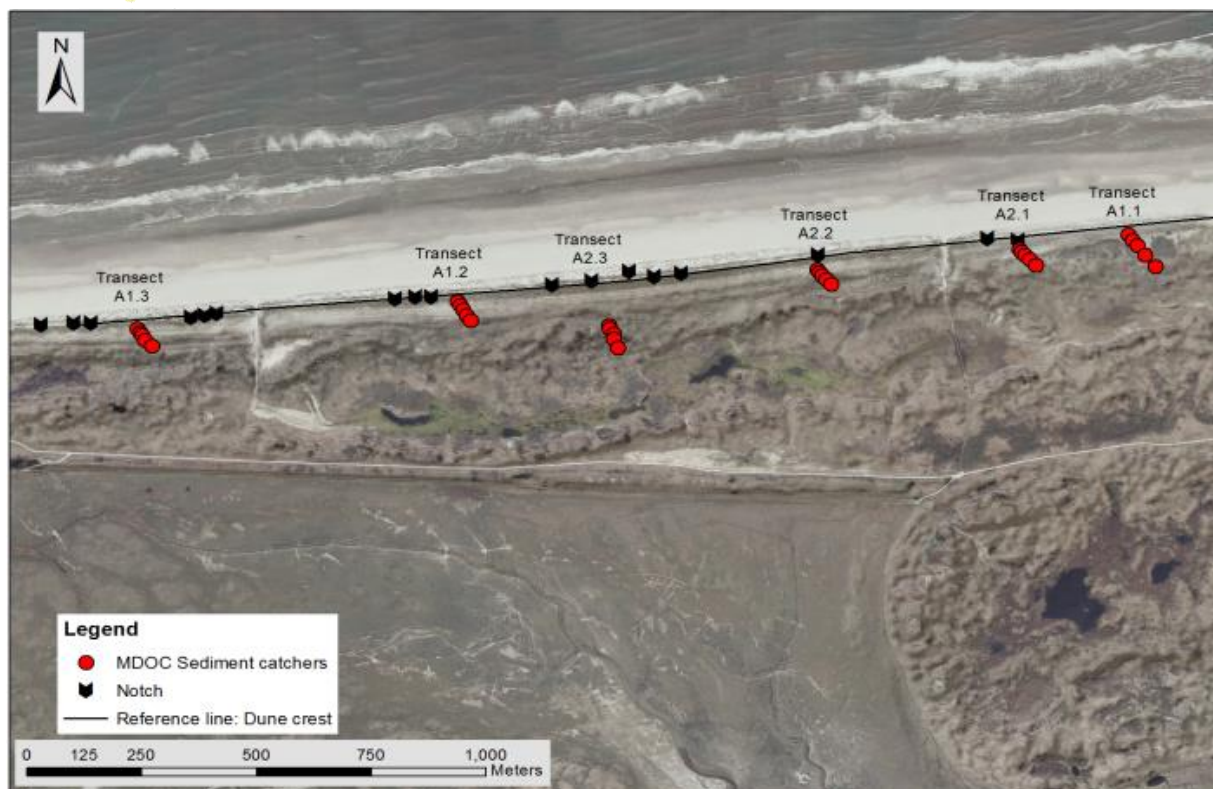
Figuur 7.4. Ligging van in 2011 aangebrachte kerven in de zeereep op Oost-Ameland (zwarte markering) en zandvanginstallaties (rode markering) om doorstuiving van zand te meten.
