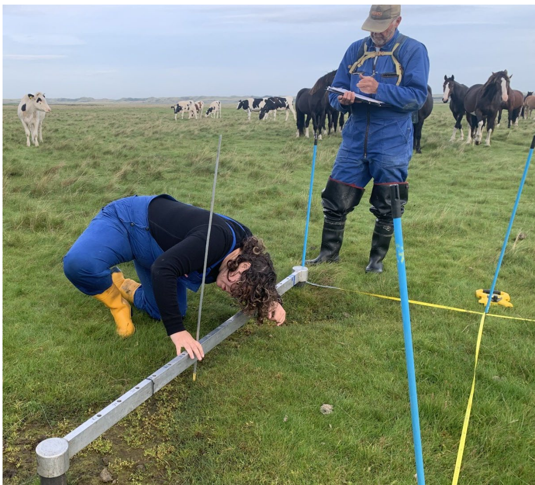
Metten van sedimentatie met de Sedimentatie Erosie Balk
